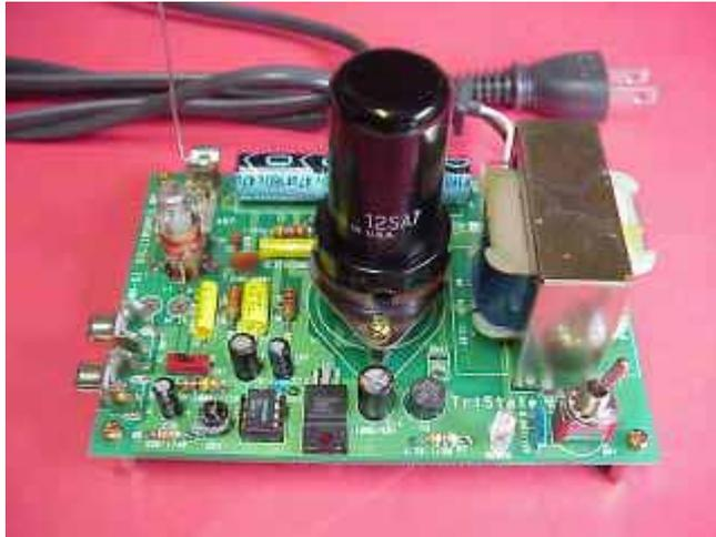
12SA7又は6SA7メタル真空管を使用した、AM中波帯のモノラル・微弱トランスミッター（送信機）キットです。
