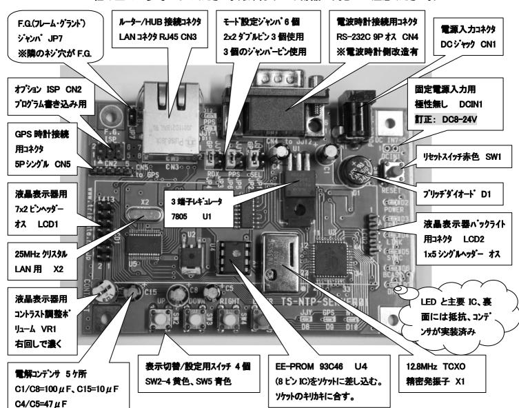
液晶表示器は、2個のピンヘッダー用ソケットをハンダ付けします。
